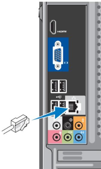
Não é necessária uma conexão de rede para concluir a configuração deste computador, mas se você já tiver uma conexão de rede ou Internet por cabo (como uma tomada de Ethernet ou modem a cabo), conecte-a agora. Somente use cabo de Ethernet (conector RJ45). Não tente conectar um cabo telefônico (conector RJ11) ao conector de rede.
